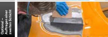
► Führen Sie das erste Schleifen mit einem Handblock durch, um Hoch- und Tiefstellen im Reparaturbereich zu erkennen
